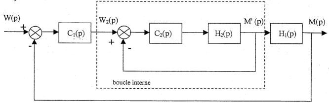
L'intérêt de mettre en place une régulation cascade consiste à remplacer la fonction de transfert  $H_2(p)$  par une fonction en chaîne fermée  $F_2(p)$  plus rapide.
