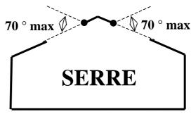
Le mouvement de chaque ouvrant se fait par la mise en rotation d'un moteur de type asynchrone triphasé couplé à un réducteur de vitesse et alimenté par le variateur.
