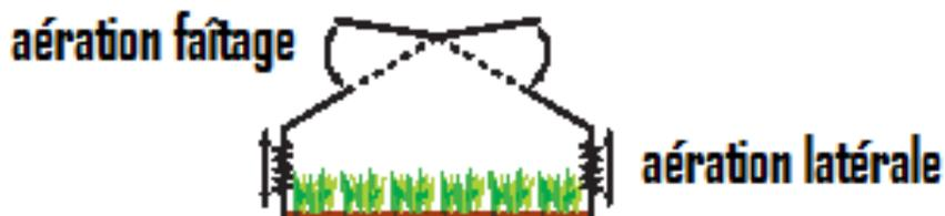
L'aération au faîtage se fait par deux ouvrants disposés sur la structure côté nord. La circulation de l'air extérieur dans la serre est contrôlée par l'angle d'ouverture des ouvrants comme indiqué sur le schéma ci-dessous :
