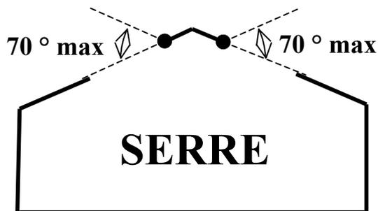
Le mouvement de chaque ouvrant se fait par la mise en rotation d'un moteur de type asynchrone triphasé couplé à un réducteur de vitesse et alimenté par le variateur.
