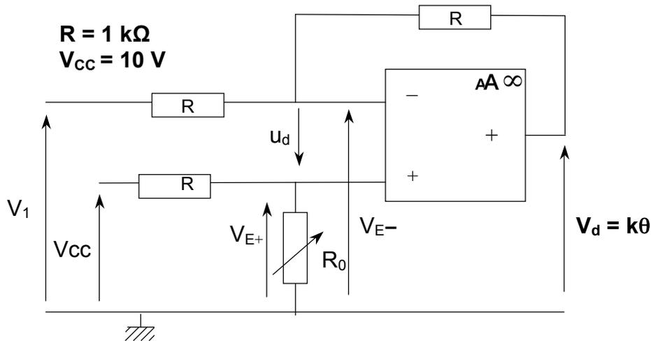
**A.II.1** Exprimer la tension  $V_{E-}$  de l'entrée inverseuse en fonction  $V_1$  et de  $V_d$ .
