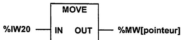
Où le **pointeur** est un mot (ici %MW4), écrit entre crochets [ ]. Ce pointeur contient lui-même l'adresse considérée décalée de 3 bits à gauche (soit multipliée par 8 en décimal). Dans l'exemple ci-dessus, si %MW4 contient **3 392**, la mesure %IW20 sera rangée à l'adresse %MW**424**.
